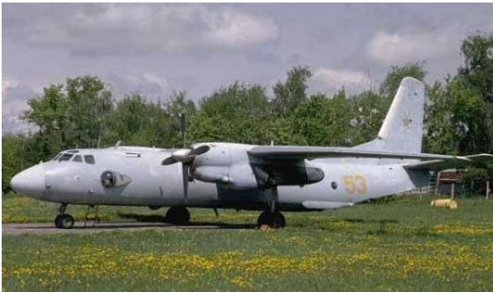
尺寸数据：翼展 29.20 米，机长 23.80 米，机高 8.58 米，机翼总面积 74.98 米<sup>2</sup>，空勤人员舱门高×宽 1.40 米×0.60 米、离地高度 1.47 米，货舱地板长 11.50 米，货舱宽度 2.40 米，货舱最大高度 1.91 米。
